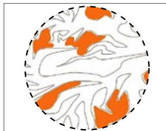
Structure des pores avec système de pores dopés de manière conventionnelle
